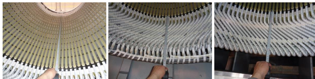
Obrázek 29 – Ukázka kontroly rozměrů
