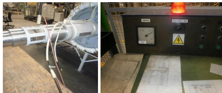
Obrázek 4 – Ukázka zapojení (vlevo) a nastavení měřícího zařízení (vpravo) pro měření přiloženým napětím
