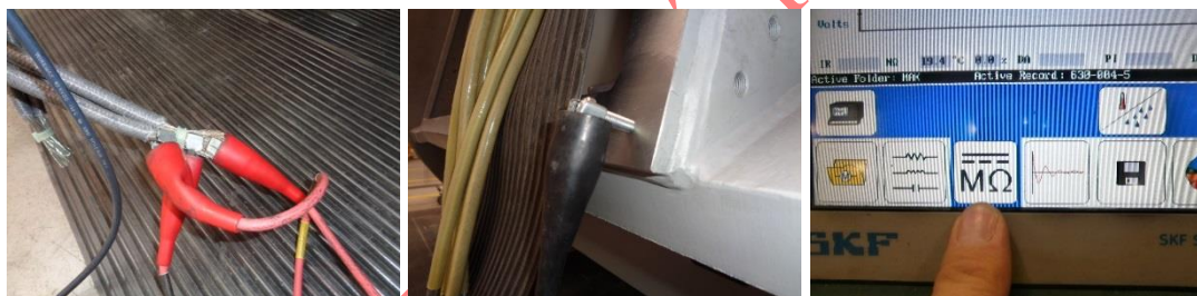
Obrázek 33 – Ukázka zapojení (dva vlevo) a měřící obrazovky přístroje (vpravo) pro měření izolačního odporu statoru
