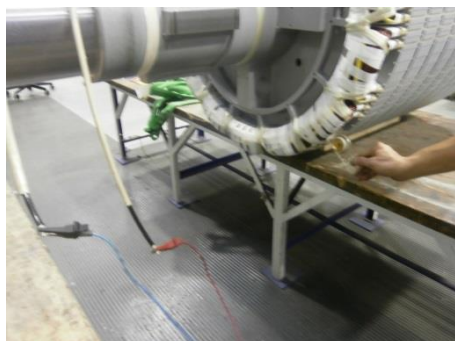
Obrázek 5 – Ukázka kontroly polarity
