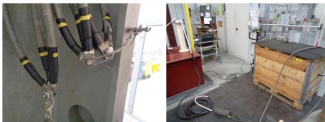
Obrázek 10 – Ukázka provedení přípravy pro měření ČV
