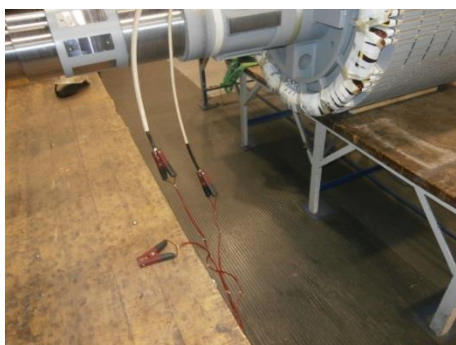
Obrázek 6 – Ukázka měření odporu přístrojem Baker
