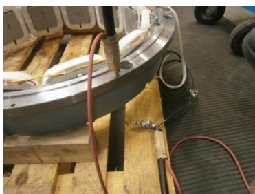
Obrázek 17 – Ukázka zapojení pro měření přiloženým napětím na budiči
