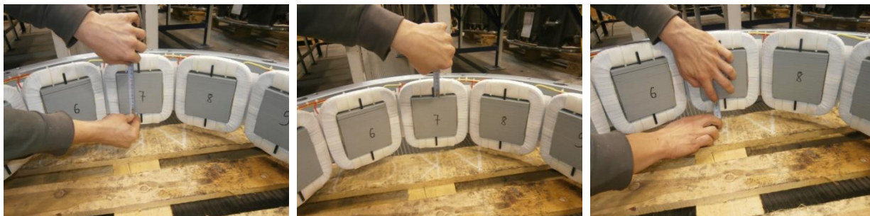
Obrázek 14 – Ukázka kontroly rozměrů statorového budiče s magnety
